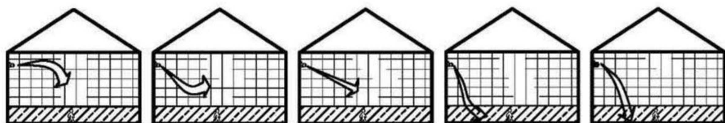
侧送风制冷工况 侧送风制热工况 侧送风过渡季节 侧送风预热工况 侧送风预冷工况
